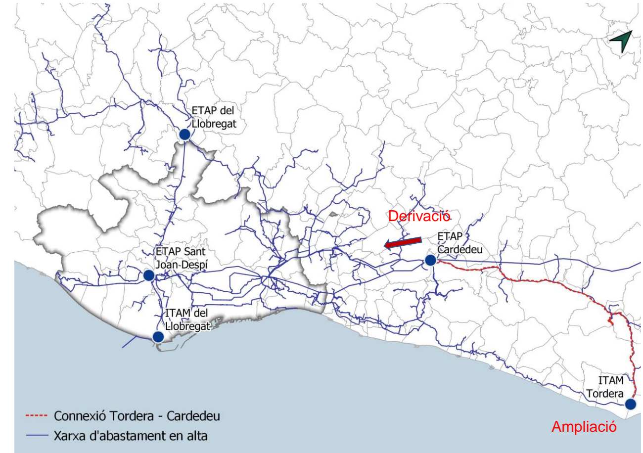
Imatge 343. Esquema de les connexions entre la planta de la Tordera i l'àrea metropolitana
