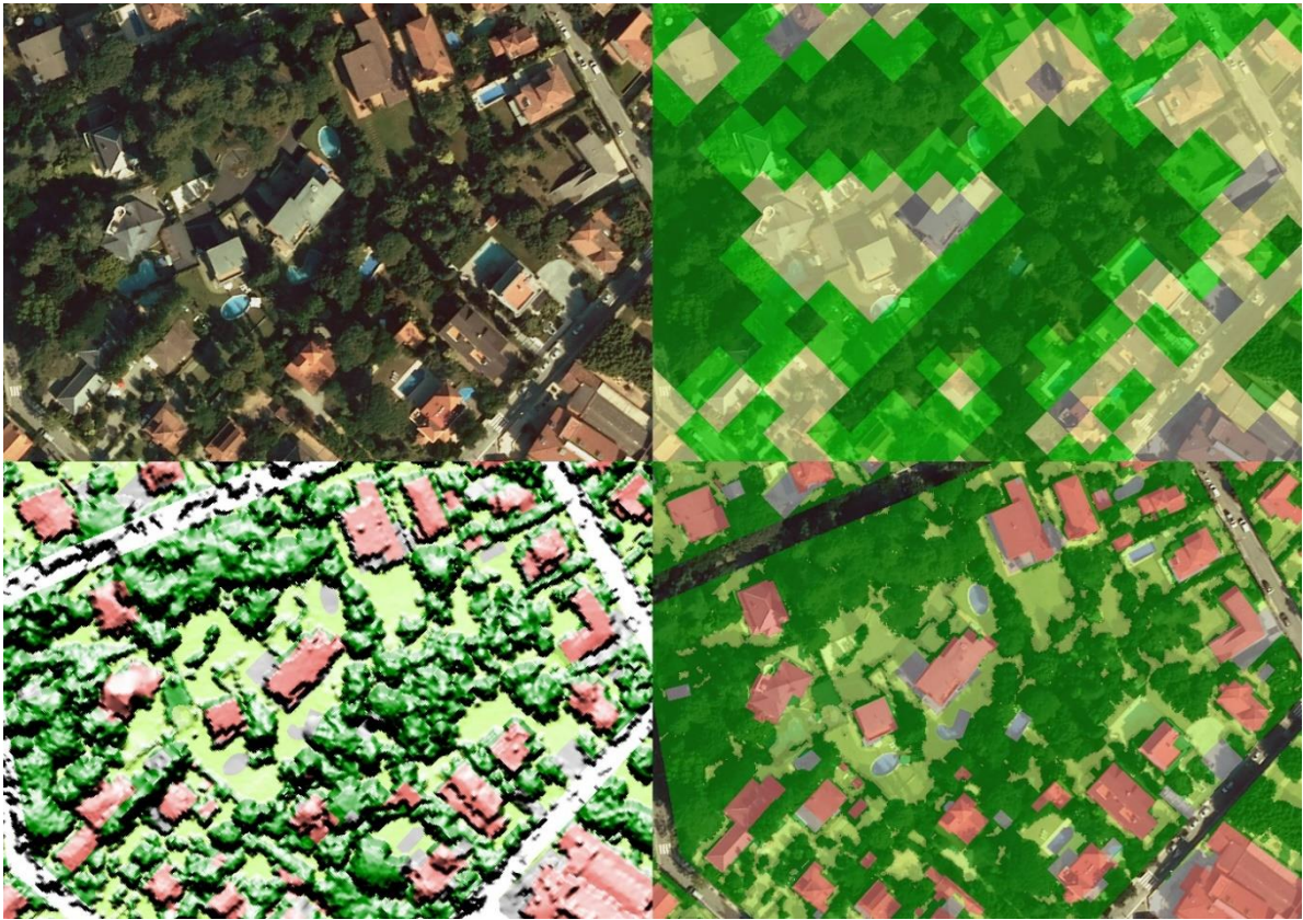
Imatge 11: Procés d'identificació de les superfícies vegetades: ortofoto (superior esquerra), NDVI (superior dreta), LIDAR (inferior esquerra), resultat final (inferior dreta)
